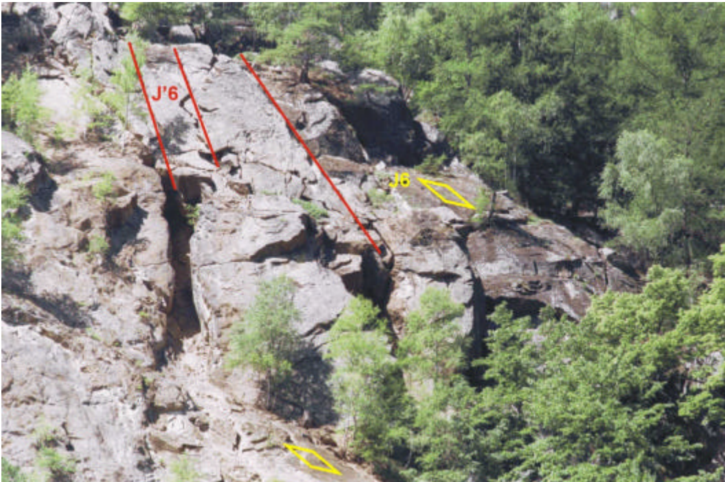
Figure 6: Photo d'une instabilité de glissement superficiel sur une discontinuité J6.
