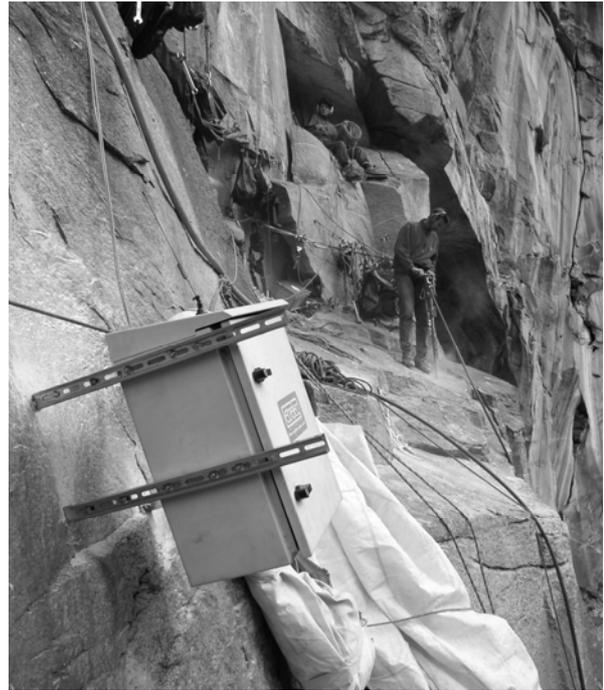
**Figure 5.** Station de mesure extensométrique avec télétransmission mise en place pour assurer la télésurveillance via Guardaval de la falaise de Rudewand.
