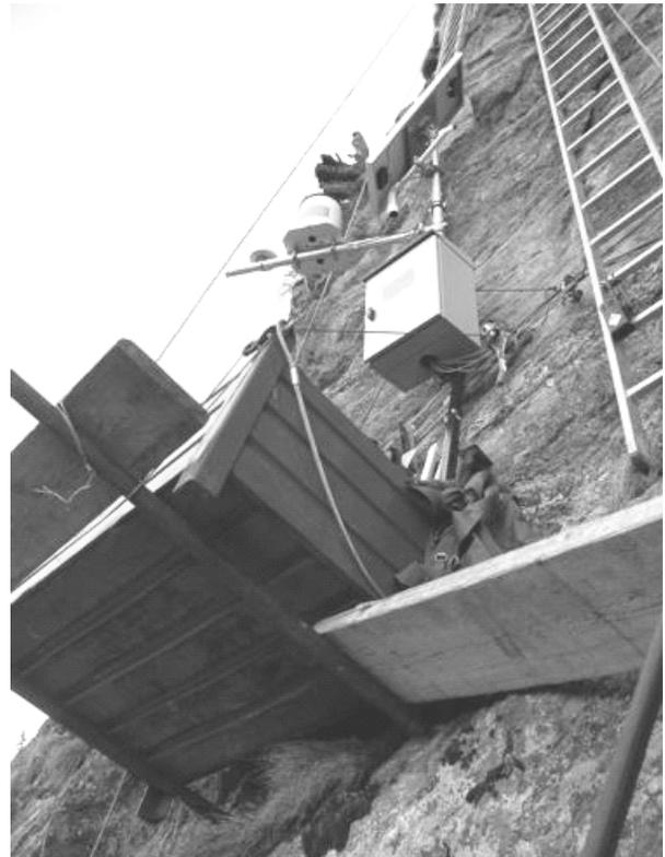
**Figure 7.** Station de mesure extensométrique avec télétransmission mise en place pour assurer la télésurveillance via Guardaval du site de Deibfels.
