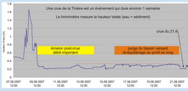
Parallèlement on observe un dépôt de matériaux à l'amont de la station. Entre le 11 et le 21 Août, le débit liquide est stable, ce qui implique que les variations de hauteur observées sont représentatives d'une respiration sédimentaire du lit, avec une tendance vers le dépôt. Le lit n'étant pas encore stabilisé, la crue du 21 Août remobilise une partie du lit.
