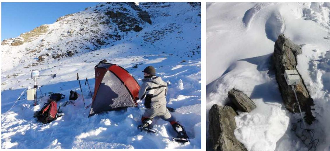
Figure 7 : Mise en place sur le « glacier » Bonnard du réseau de mesure de T° au sol
