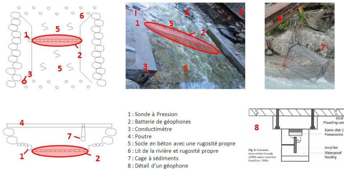
Figure 11 : Dispositif d'équipement de la station de mesure dans la Navisence
